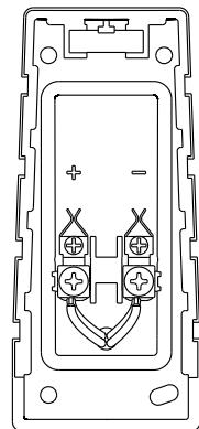
Рис. 4.4: Проводка для настенного кронштейна: вид спереди
