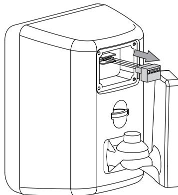
2. Подключите **соединитель перемычки** в разъем Euroblock, соблюдая нужные параметры трансформатора.
