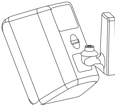
3. Затяните **фиксирующий болт** с помощью универсального гаечного ключа (входит в комплект).
