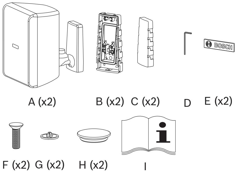
Рис. 3.1: Список компонентов для акустических систем без трансформатора
