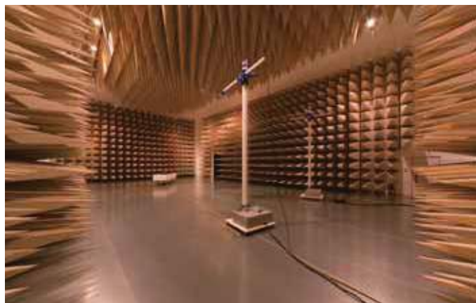
Большая камера для испытаний на электромагнитную совместимость
