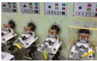
Испытания кодирующих устройств на долговечность
