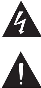
Der Blitz mit nach untenzielendem Pfeil in einem gleichseitigen Dreieck weist den Benutzer auf das Vorhandensein einer unisolierten, "gefährlichen Spannung" im Gehäuse hin, die stark genug sein kann, einer Person einen gefährlichen elektrischen Schlag zu versetzen.
