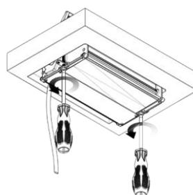
Поместив устройство в отверстие, закрепите его, закрутив два крестообразных винта в нижней части продукта.
